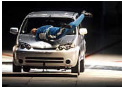
Fußgänger-Crashtest bei Honda (Aufprallgeschwindigkeit 40 km/h): "Parallelen zum Bewegungsablauf beim Stabhochsprung"
